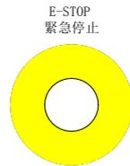
在危險或緊急的狀況下壓下這個鍵鈕，將停止所有動作。解除按鈕的方法是依按鈕上的箭頭方向，將按鈕旋轉，按鈕將自動放開跳起解除。當按鈕被壓下來時後，系統狀態處於準備未完成情況(狀況欄位會顯示準備未完成)。而且爲了達到徹底的安全,電控箱中的進驅電源將被切斷。解除緊急停止前，先確認故障原因是否排除，且緊急停止解除後應重新執行原點復歸的動作，以確保座標位置的正確性。
